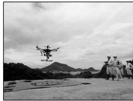
写真1 UAV3次元レーザー測量技術の導入効果に関する実証実験の風景
