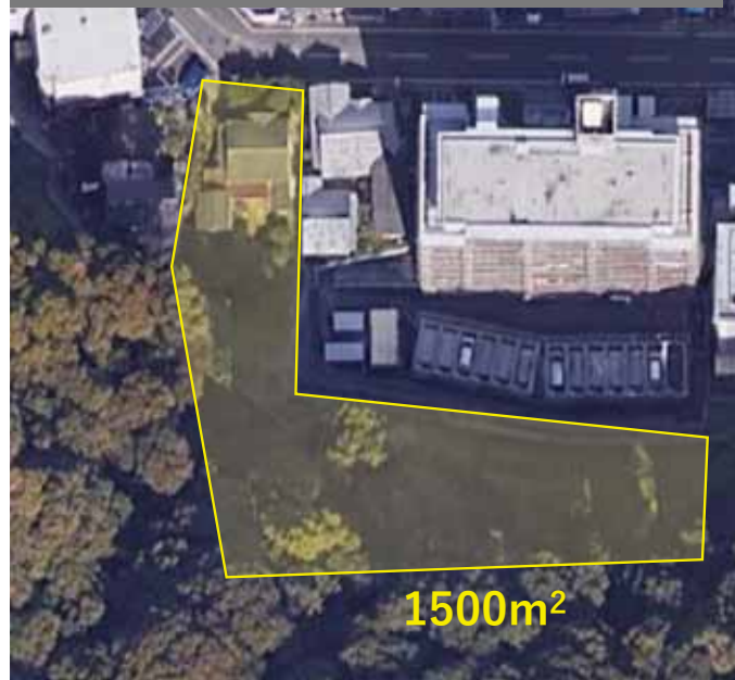
1回目の崩壊による想定堆積範囲
