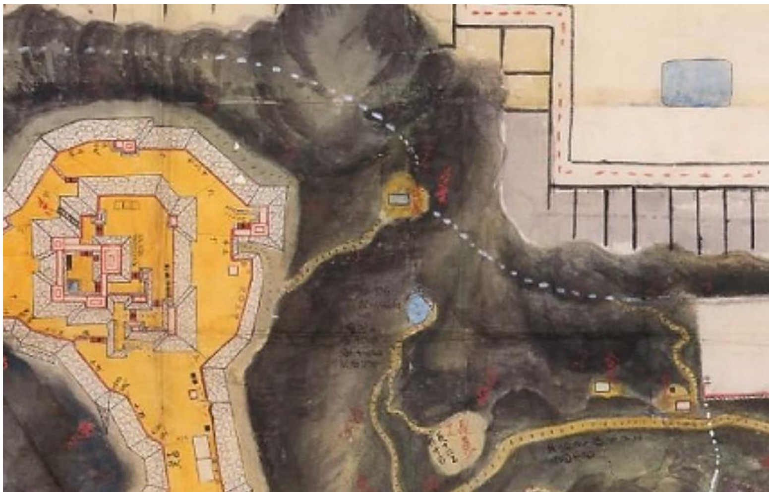
亀郭城秘図(部分) 1864(文久4)年 伊予史談会蔵 今回の斜面崩壊地もしくはその南側に池が描かれている。
