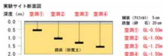
図-11 テスティールド断面図 測線1
