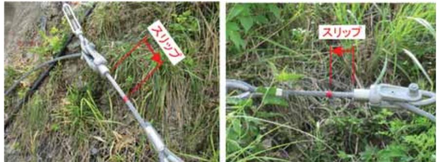
写真 3-3 緩衝装置の作動状況
