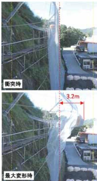
写真 3-4 阻止面の水平変位(CASE-1)
