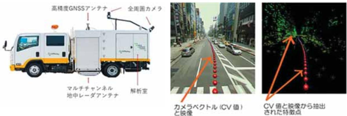
写真-4 路面下空洞探査車両の構成
