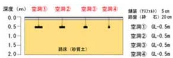
図-12 テスティールド断面図 測線2
