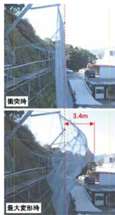
写真 3-5 阻止面の水平変位(CASE-2)
