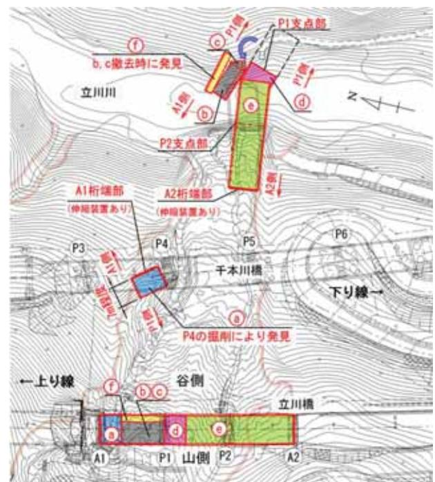
図-2 立川橋上部工流出位置図
