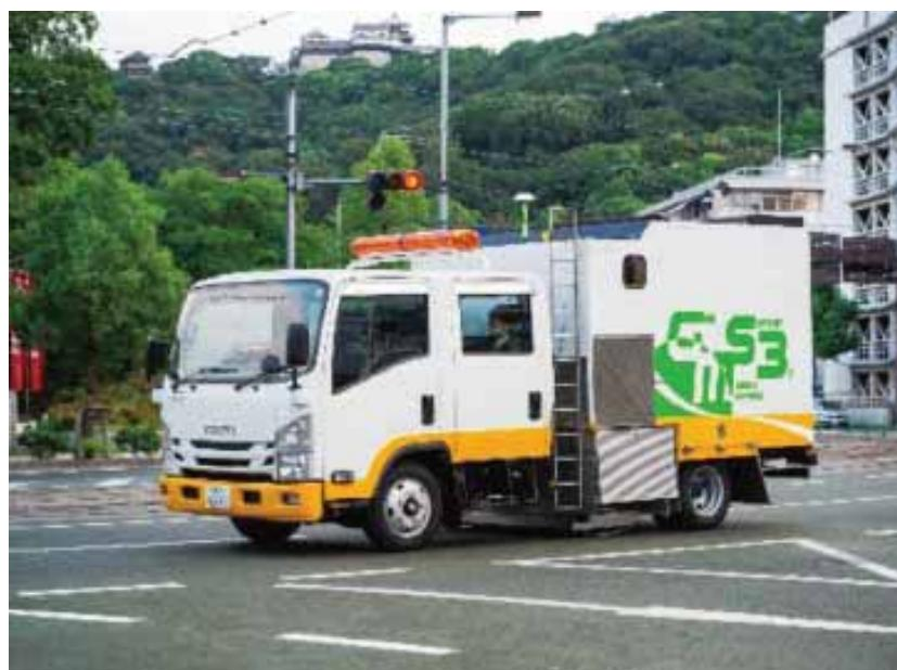
カナンジオリサーチ社開発の GMS3 は 3 次元地中レーダによる地下情報とモバイルマッピングシステムによる地上情報の全方位連続 3 次元化を時速最大 80km で実現している。
