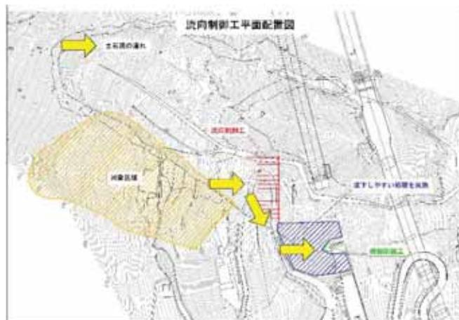
図-7 流向制御工配置図
