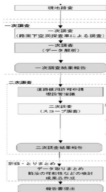
図-1 空洞調査の流れ
