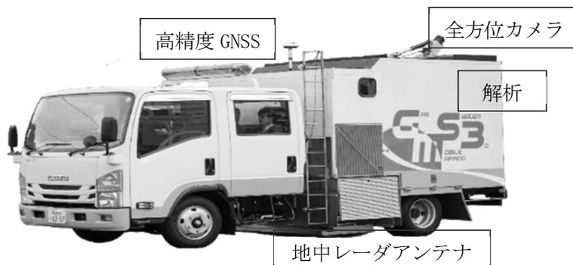
写真-1 探査車両に取り付けたGNSSアンテナ、地中レーダ、全周囲カメラの構成
