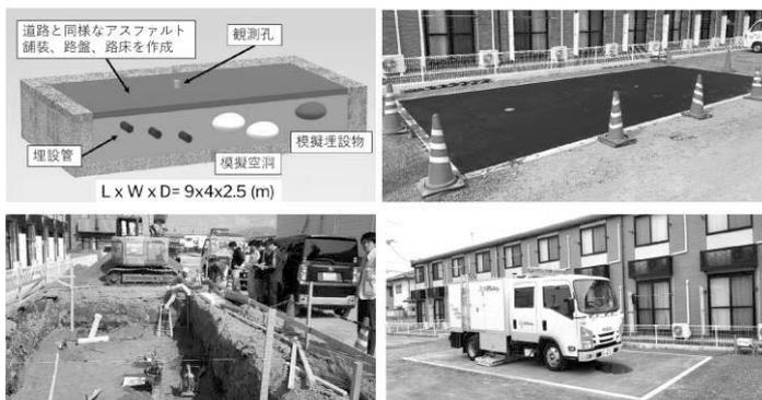
図4 地中レーダテストフィールド
