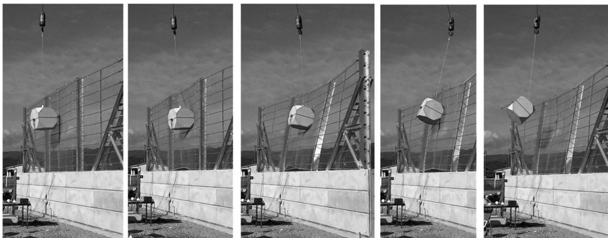
写真 3 防護柵へ重錘が衝突したときの挙動(ケース 1 の実験)
