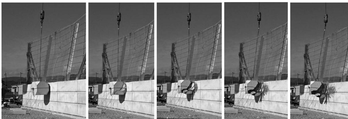
写真 4 擁壁壁面へ重錘が衝突したときの挙動(ケース 2 の実験)
