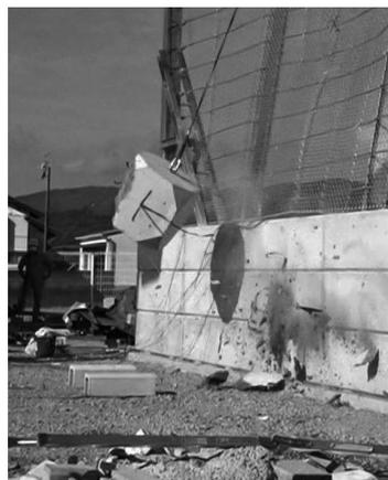
擁壁壁面に重錘が衝突（跳ね返り時）
