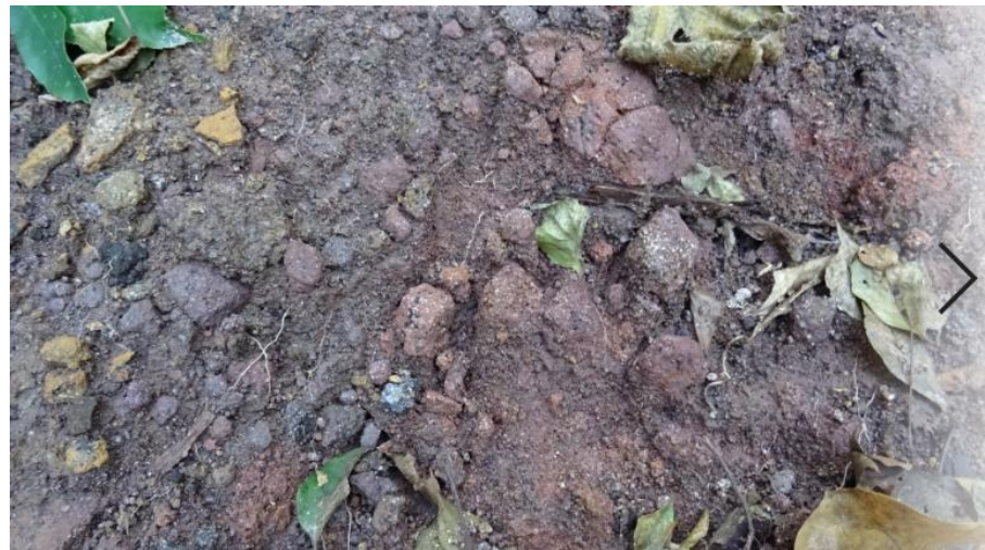
住宅背後斜面の崩壊，火山灰質土の中に玉石状の溶結凝灰岩の転石
