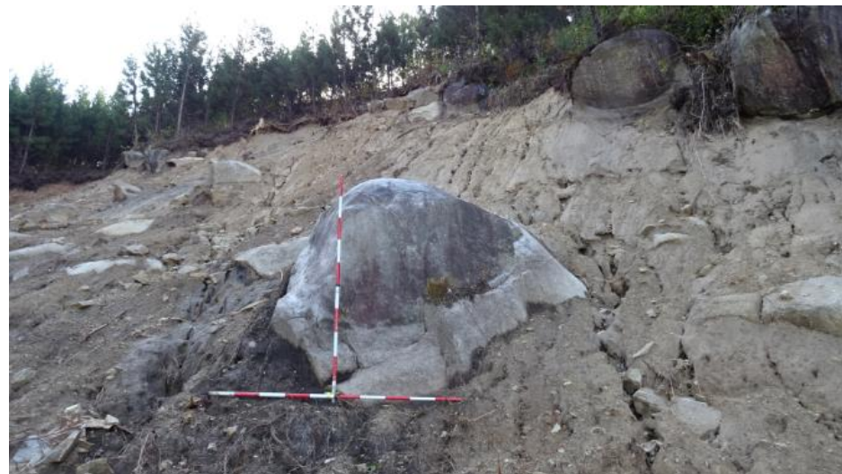
側方滑落崖をすべり落ちてきたコアストーン
