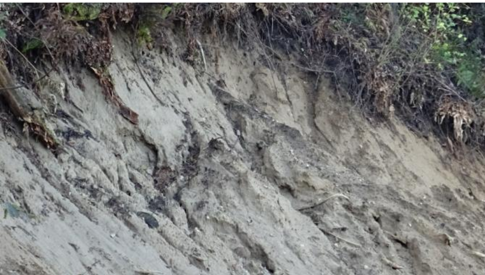
側方滑落崖の上方の土砂化（まさ化）した表層
