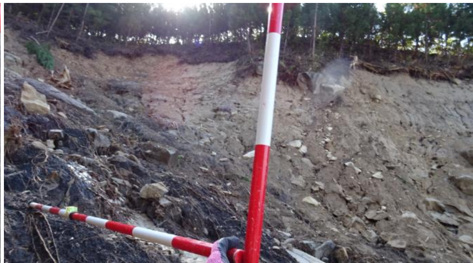
溪流全長にわたり水平2m間隔で傾斜測定
