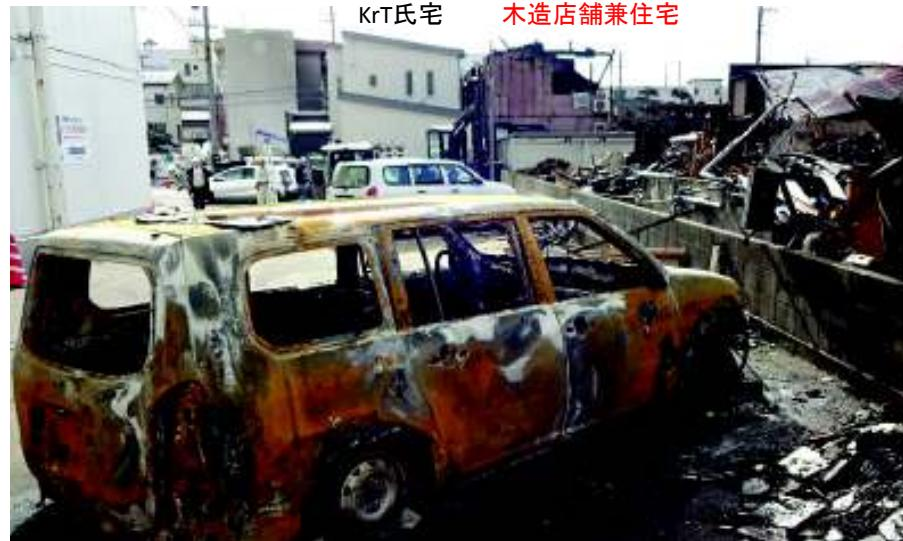
東側と北側は隣接駐車場のため延焼のリスクは低い。北側の火災が南風のために南東側KrT氏宅に延びることがなかった。 車両は、金属部以外は全て溶け落ちて焼失している(タイヤ、ドアノブ、ガラス、ランプ類、シートクッション)。
