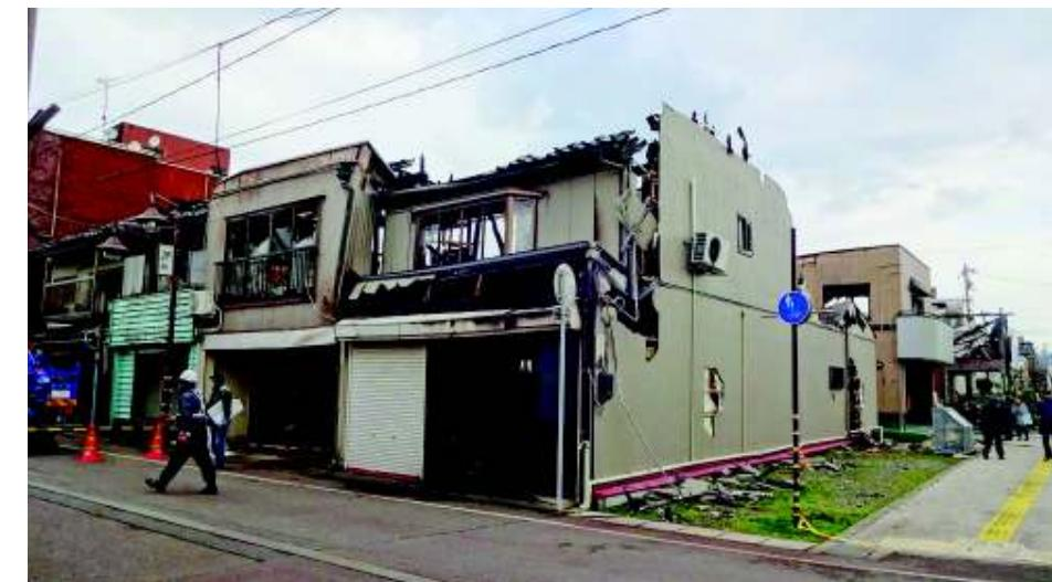
写真左側は西。写真の中央の建物(南隅)の右側(南側)には「みいちゃん通り」があり、輻射による延焼は避けられた。この一画は北東側が焼失しており、飛び火により着火したものと思われる。
