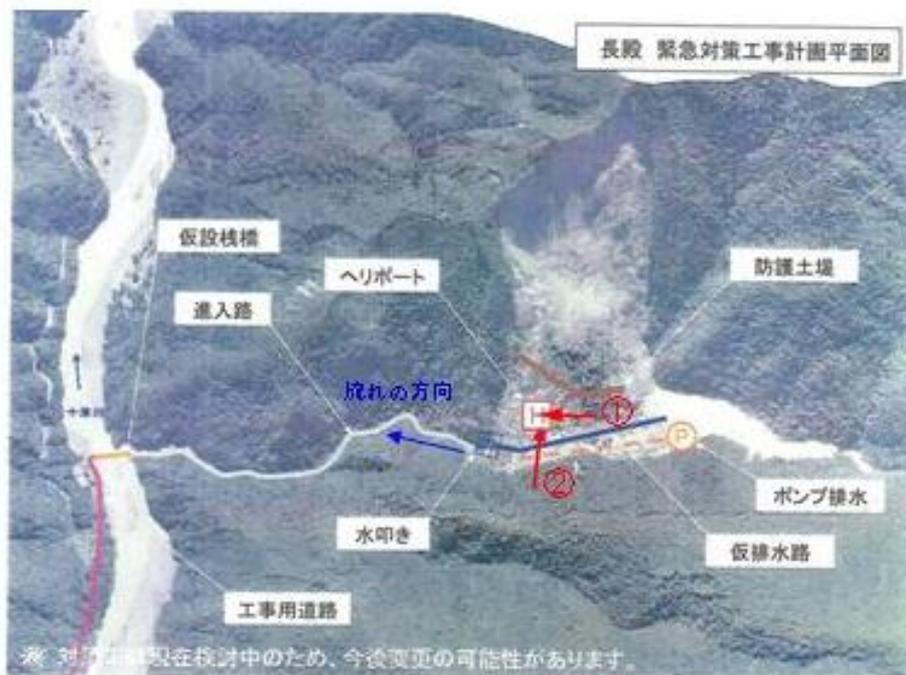
長殿 緊急対策工事計画平面図
